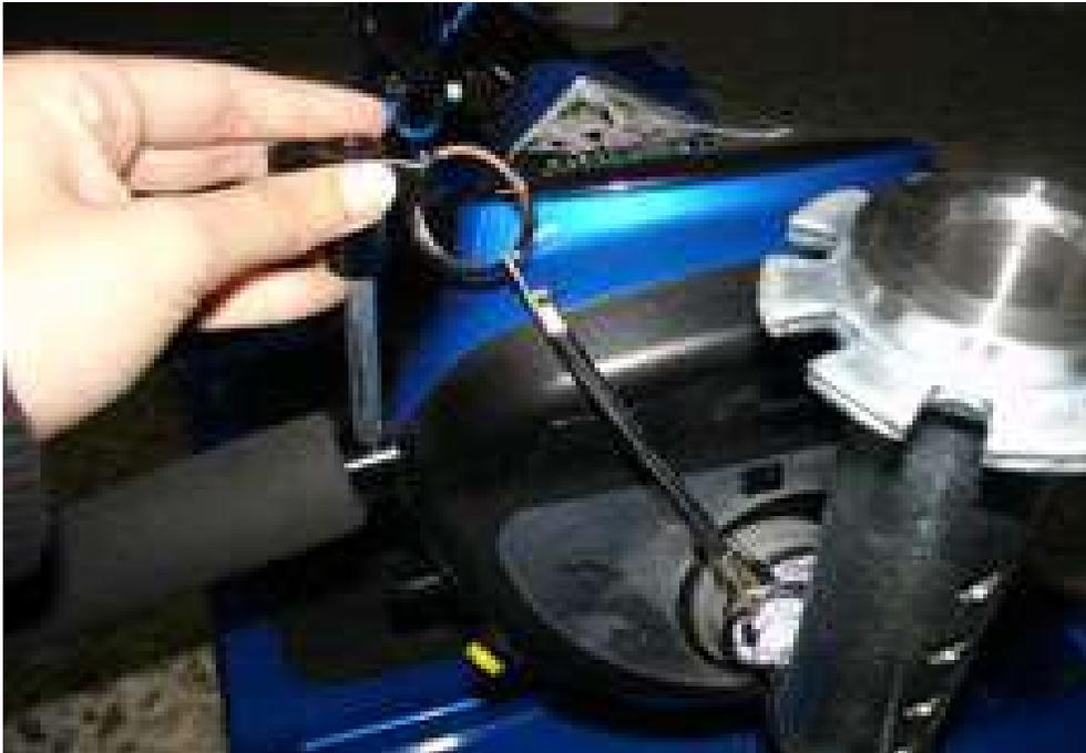
Insertando el mismo pin de bloqueo de las baterías en el orificio de la empuñadura izquierda, el manillar queda bloqueado para que no se mueva durante el transporte.
