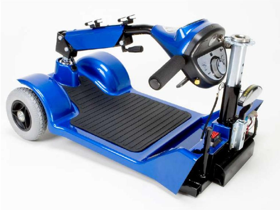
Girando la palanca hacia la derecha se libera el manillar que puede abatirse completamente
